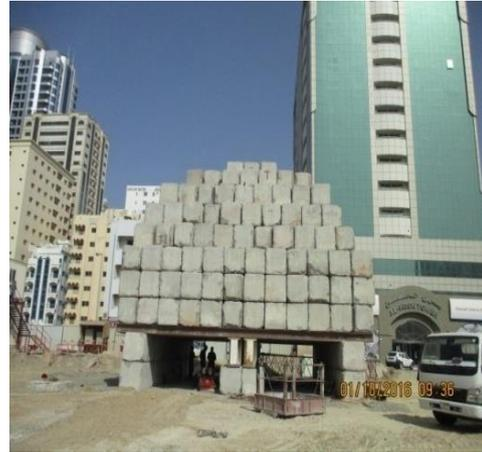
اختبار التحميل الإستاتيكي للأوتاد ( Static Pile Load Test )
