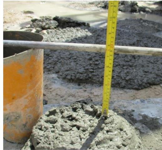
اختبار الهبوط الخرسانة ( Slump Test )
