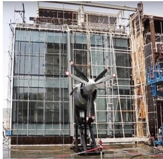
ماكينات ضغط الهواء ودفع المياه لإختبار الحوائط الستائرية
