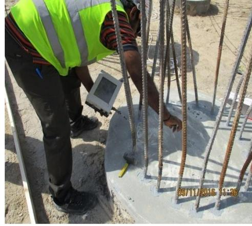
اختبار التجانس (Integrity Test)
